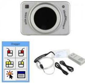
**제 품 개 요** 지체/뇌병변등의 장애로 인해 상지를 사용하기 어려운 경우 적외선을 이용하여 난반사타켓을 이마 등에 붙이고 머리를 움직여서 마우스커서를 이동하는 특수마우스입니다. 마우스 클릭 기능을 프로그램 이용방식과 호흡을 이용한 방식 두 가지 다 사용할 수 있습니다.
